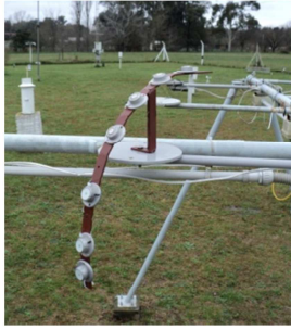
Figura 1: Estructura para colocar los sensores en planos inclinados.
