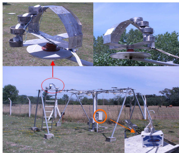
Figura 2: Estructura sobre la cual se montaron los sensores en planos inclinados con las máscaras para eliminar el albedo, y los datalogger en un recipiente estanco.
