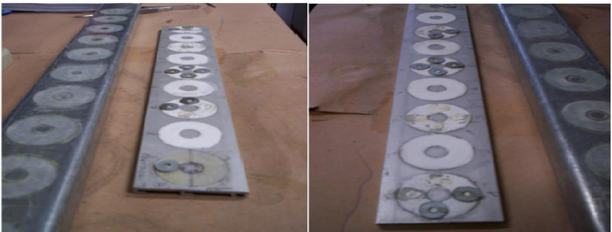
Figura 6: Probetas para el ensayo de adherencia
